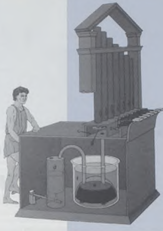
Waterorgel. Een slaaf zorgt door te trappen voor druk op het water, zodat een organist geluid uit de pijpen kan krijgen.
