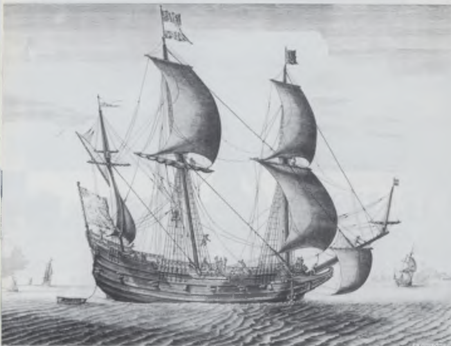
Bewapend fluitschip, circa 1650. Gedurende eeuwen het belangrijkste type koopvaardij-schip. Door het simpele tuig was een bemanning van twintig koppen genoeg voor een grote fluit.
