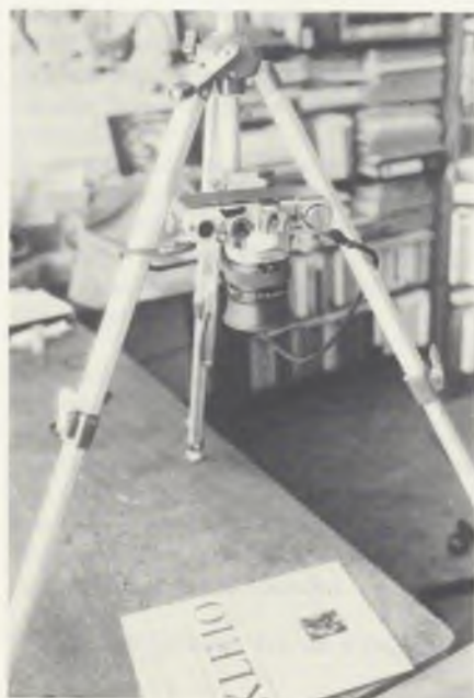
Repro-opstelling met een statief en omgekeerde middenzuil.
