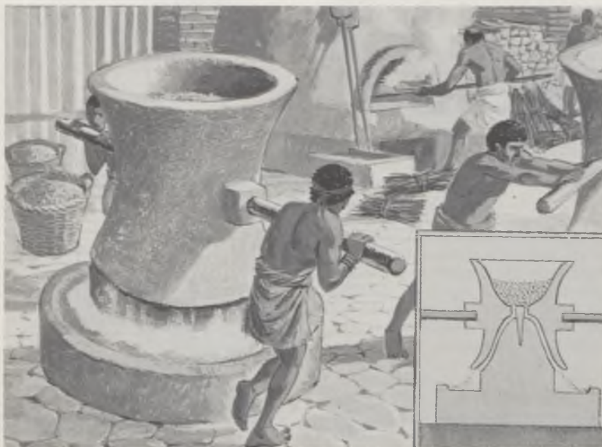
9. Impressie van een pistrinum met door slaven aangedreven molen.
