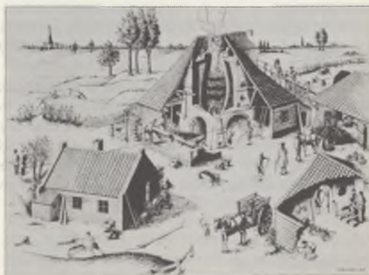
Rekonstruktie van een 18e eeuwse houtskoolhoogoven in de Gelderse Achterhoek, naar gegevens van de D.R.U. te Ulfst (Foto Ned. Open-luchtmuseum).
